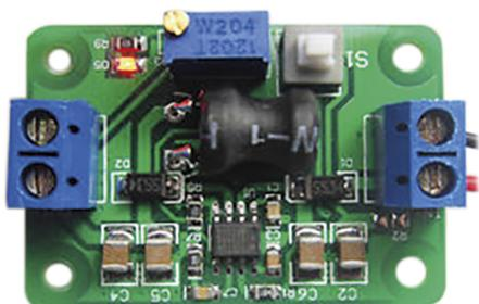
Este dispositivo es un módulo reductor de tensión de alto rendimiento con tecnología conmutada y 2.5A de corriente.
