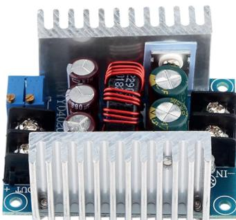
Este dispositivo es un módulo reductor de tensión de alto rendimiento con tecnología conmutada y 10A de corriente.
