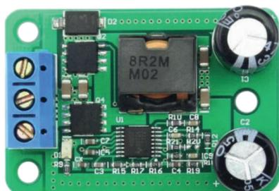
Este dispositivo es un módulo reductor de tensión de alto rendimiento con tecnología conmutada y 5A de corriente.
