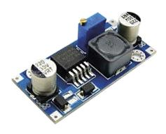
Este dispositivo es un módulo reductor de tensión de alto rendimiento con tecnología conmutada y 2A de corriente.
