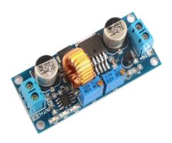
Este dispositivo es un módulo reductor de tensión de alto rendimiento con tecnología conmutada y 3.5A de corriente. Este módulo es la segunda generación de tecnología de conmutación de alta frecuencia y utiliza el chip XL4015E1.
