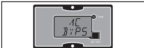
9. Modo by-pass con tensión AC de entrada
