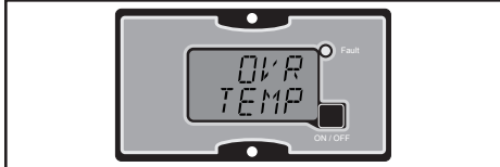
7. Protección por sobretemperatura
