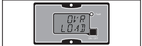
8. Protección por sobrecarga o cortocircuito
