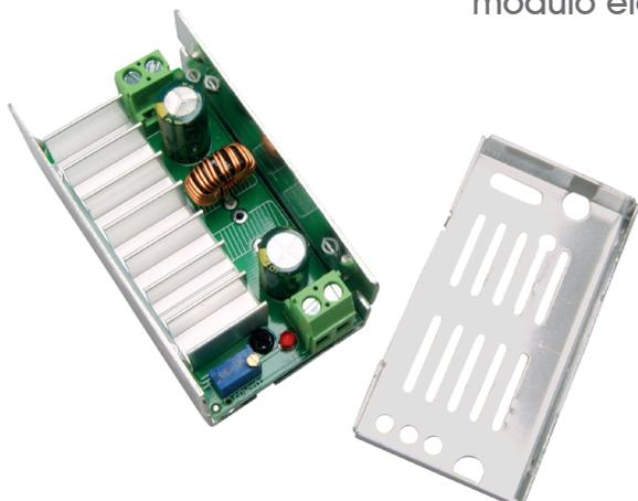
Este dispositivo es un módulo elevador de tensión de alto rendimiento con tecnología conmutada y 7A de corriente.
