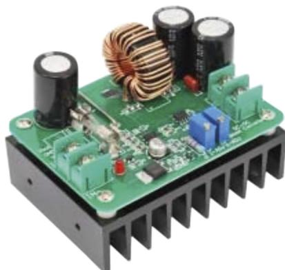
Este dispositivo es un módulo elevador de tensión de alto rendimiento con tecnología conmutada y 10A de corriente.
