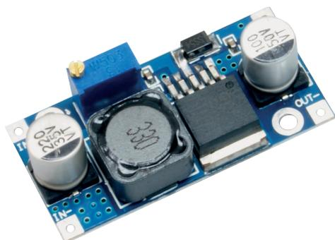
Este dispositivo es un módulo elevador de tensión de alto rendimiento con tecnología conmutada y 0.5A de corriente.
