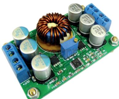
Este dispositivo es un módulo reductor de tensión de alto rendimiento con tecnología conmutada y 6A de corriente.
