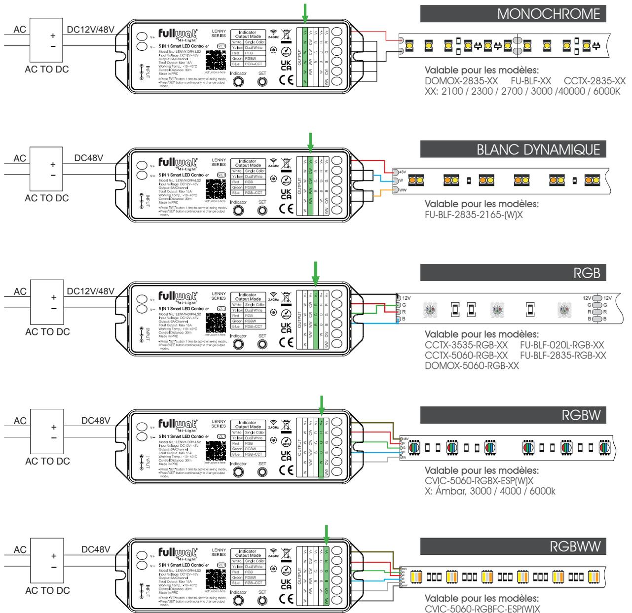
À travers le bouton «Switch» nous devons indiquer le type de produit à contrôler. Appuyez le bouton poussoir «Switch» ou «SET» successivement jusqu'à ce que la LED «indicator light» aura le couleur requis.
