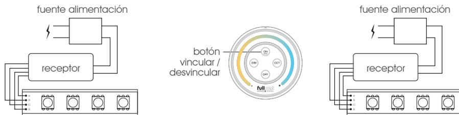
**1.** Desconecte la alimentación y después de 10 segundos, vuelva a conectar.
