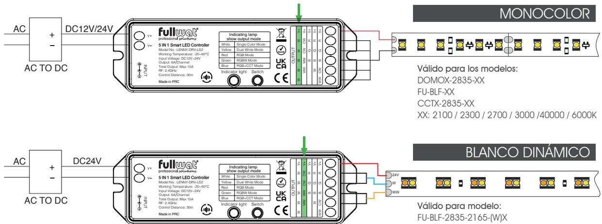
A través del botón "Switch" se puede indicar qué tipo de producto se está controlando. Para ello, iremos presionando con un toque corto el botón "Switch" o "SET" hasta que el color del "indicator light" sea del color requerido.
